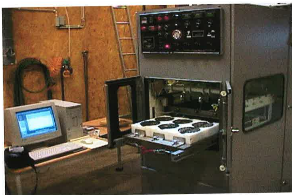
Bild 2. Wheel-track utrustning, Asphalt Pavement Analyzer
